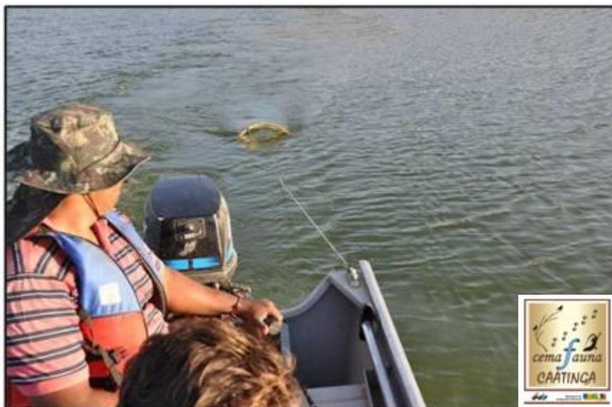
Foto 4.23.7.67. Coleta de ictioplâncton com rede cônica, arrastada na coluna de água.
