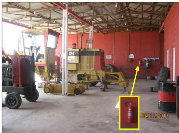
Foto 4.2.324. Oficina mecânica coberta, piso impermeável e extintor de incêndio (nov/2013).
