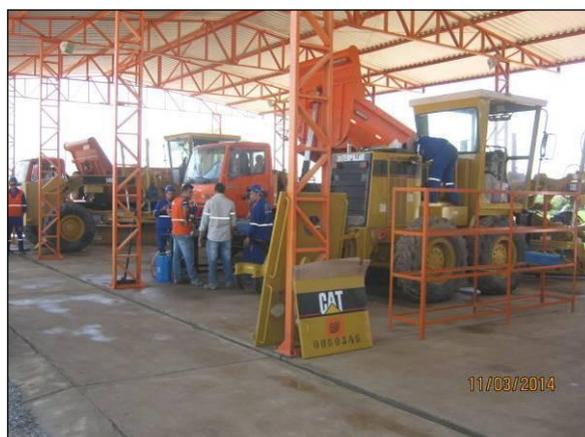
Foto 4.2.238. Oficina mecânica no canteiro central (antigo Lote 07), com canaleta, extintores de incêndio e piso impermeabilizado (fev/2014).
