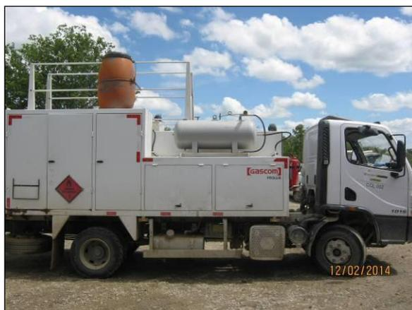
Foto 4.2.471. Caminhão comboio equipado com kit mitigação e extintor de incêndio, na frente de serviço do desemboque do túnel do Cuncas I – WBS 1410 (fev/2014).
