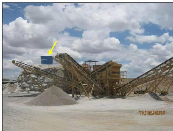
Foto 4.2.335. Britador instalado no WBS 2208 com sistema de umectação do material para minimizar a produção de poeira (fev/2014).
