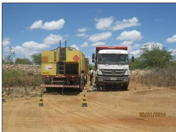
Foto 4.2.425. Abastecimento sendo realizado de maneira adequada nas frentes de serviços (jan/2014).
