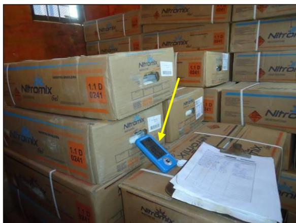
Foto 4.2.489. Paiol de armazenamento de explosivos com monitoramento de temperatura e umidade, conforme regulamentação do Ministério da Defesa (jan/2014).
