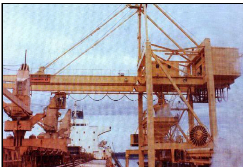
Figura 9.41: Exemplo de Ship Unloader descarregando fertilizante
