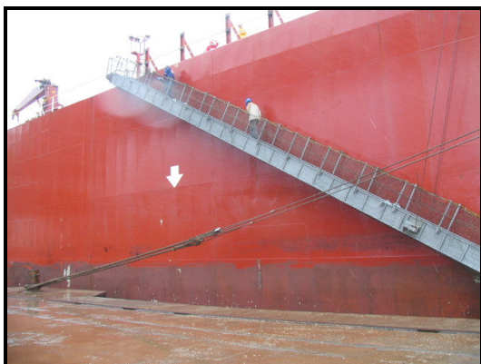
Figura 9.29: Navio atracado e fixado por amarras na borda do berço de atracação
