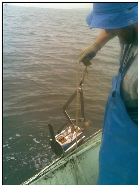
**Figura 6.58:** Lançamento da draga para coleta de sedimentos de fundo.
