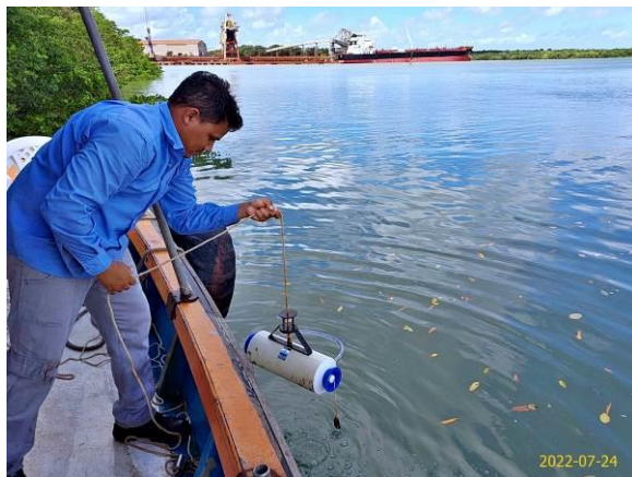
Foto 45 – Coleta das Comunidades Planctônicas (Garrafas do Tipo Van Dorn) Durante o Diagnóstico da Fauna do Terminal Privado de Regaseificação de GNL – 23M 568381/9707006
