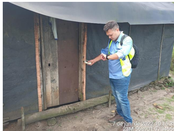
Foto 14 - Medição de vibração no Ponto 06.
