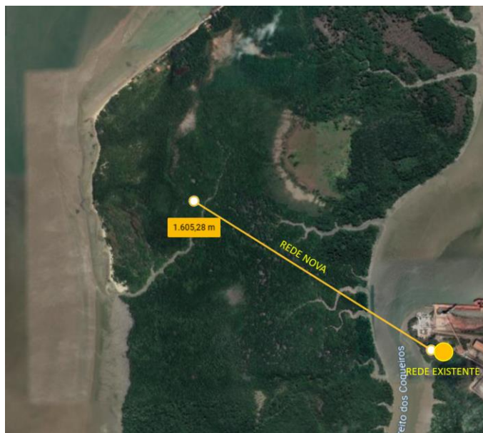
Figura 20 - Interligação com a rede de distribuição de energia mais próxima. Fonte: LC Terminais
