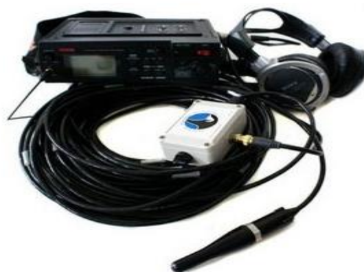
Figura 84 – Hidrofone Cetacean Research Program Modelo C55 e Gravador Digital Fostex FR2 – Equipamento Utilizado Para o Levantamento Acústico e de Ruídos Subaquáticos Durante o Diagnóstico da Fauna do Terminal Privado de GNL
