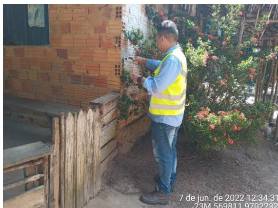
Foto 15 - Medição de vibração no Ponto 07.
