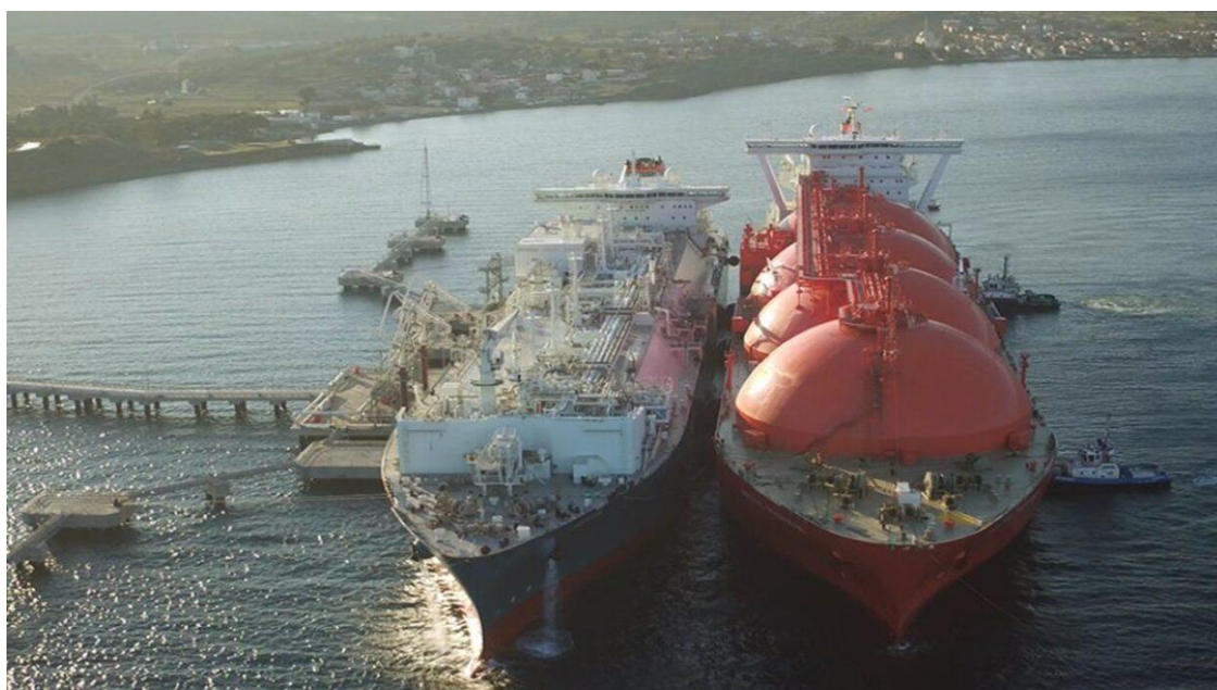
Figura 20 – Navio FSRU atracado em píer tipo ilha, com navio LNGC tipo Moss atracado a contrabordo. (Excelerate Energy, 2023)
