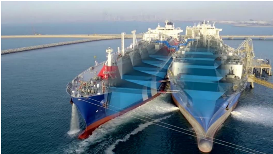
Figura 19 – Exemplo esquemático de transferência de GNL ship to ship. (Excelerate Energy, 2023)
