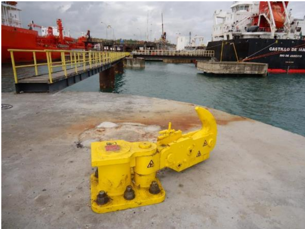
Exemplo de Gancho de Desengate Rápido (Gatos)
