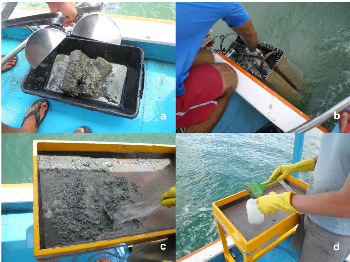
Figura 8.2-113. a) Sedimento retirado do busca-fundo do tipo Petersen ; b) Draga de arrasto adaptada de Holme com sedimento após arrasto; c) sedimento sendo lavado sobre peneira; d) sedimento sendo retirado da peneira para posterior fixação e transporte ao laboratório.
