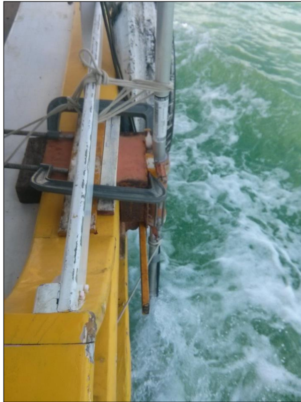
Figura 8.1-85. Transdutores dos ecobatímetros instalados em suporte na lateral da embarcação (Fonte: Bourscheid/Tetra Tech, 2014).
