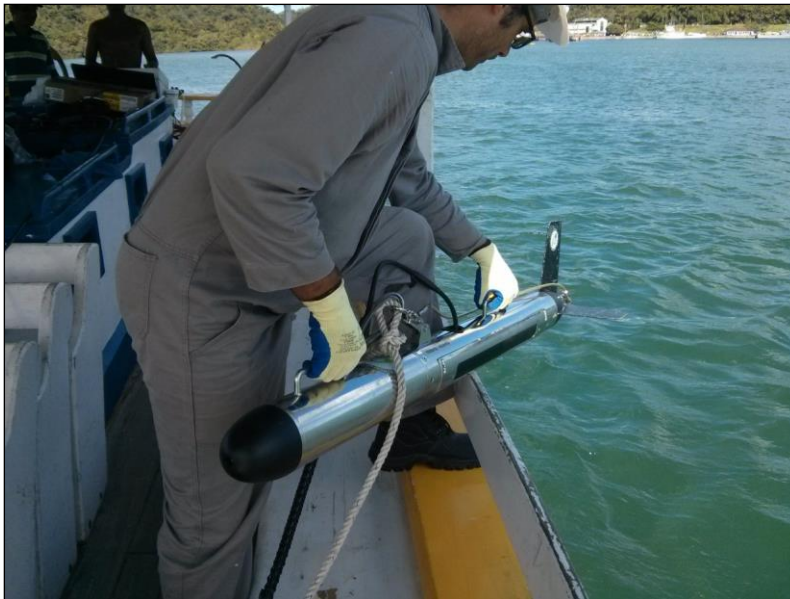
Figura 8.1-87. SVL SONAR BEAM T-150D com duas faixas de operação: 100 e 400 kHz (Fonte: Bourscheid/Tetra Tech, 2014).
