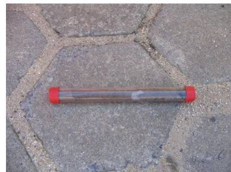
Foto 06 - Amostrador do tipo liner utilizado para coleta de solo
