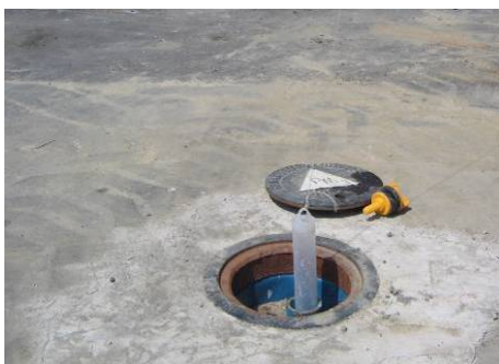
Foto 07 - Amostragem de água subterrânea com bailer
