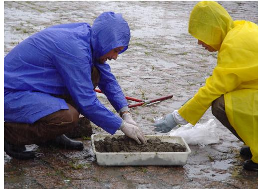
Foto 4. Envasamento do material coletado em frascarias fornecidas pelo laboratório
