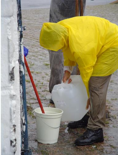
Foto 1. Lavagem do material (trado) com água destilada
