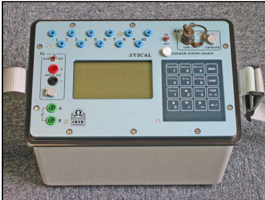
Figura 7 – Eletroresistivímetro usado (Syscal Pro).
