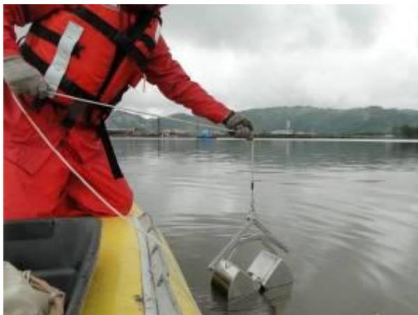
**Foto 5.2.3.3-6 Pegador Van Veen utilizado para a coleta de sedimento.**
