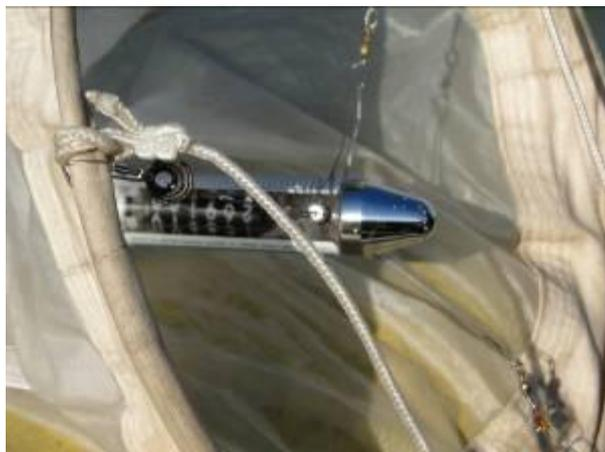
**Foto 5.2.3.3-5 Fluxômetro acoplado a rede de 200 µm para aferir o volume filtrado.**
