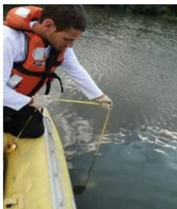
**Foto 5.2.3.3-2 Medição de transparência d'água (Disco de Secchi).**
