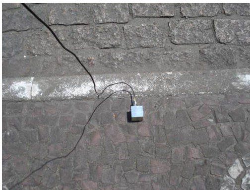
Foto 5.1.4.2-2 Acelerômetro fixado no pod metálico no eixo x.
