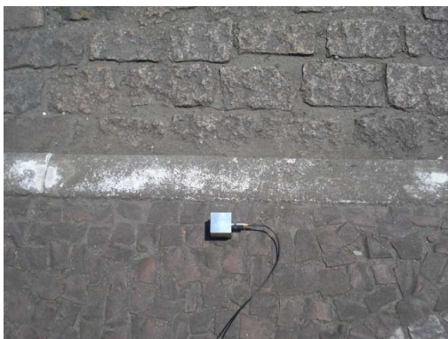
Foto 5.1.4.2-3 Acelerômetro fixado no pod metálico no eixo y.
