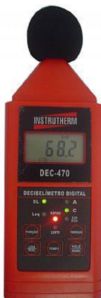
Figura 2 - Decibelímetro DEC-470, utilizado no monitoramento.
