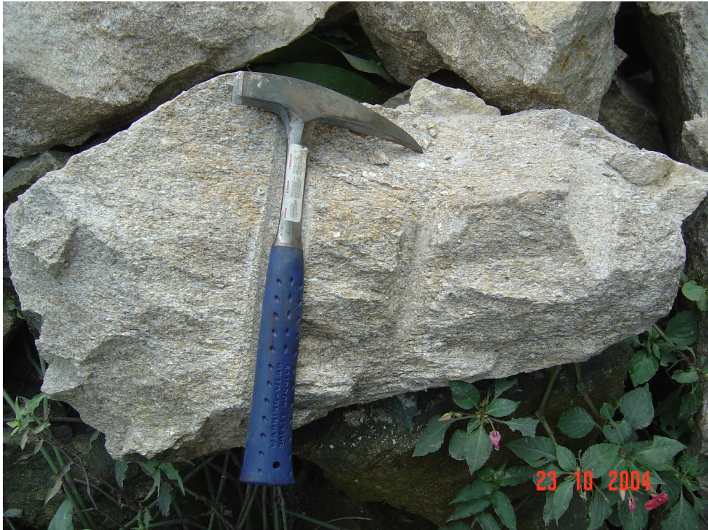
Foto 9.3-5 Amostra de rocha granitóide pertencente à unidade 22 – Maciço Granitóide Morrão, que aflora localmente em cortes dos taludes das ferrovias que ligam o Planalto à Baixada Santista.
