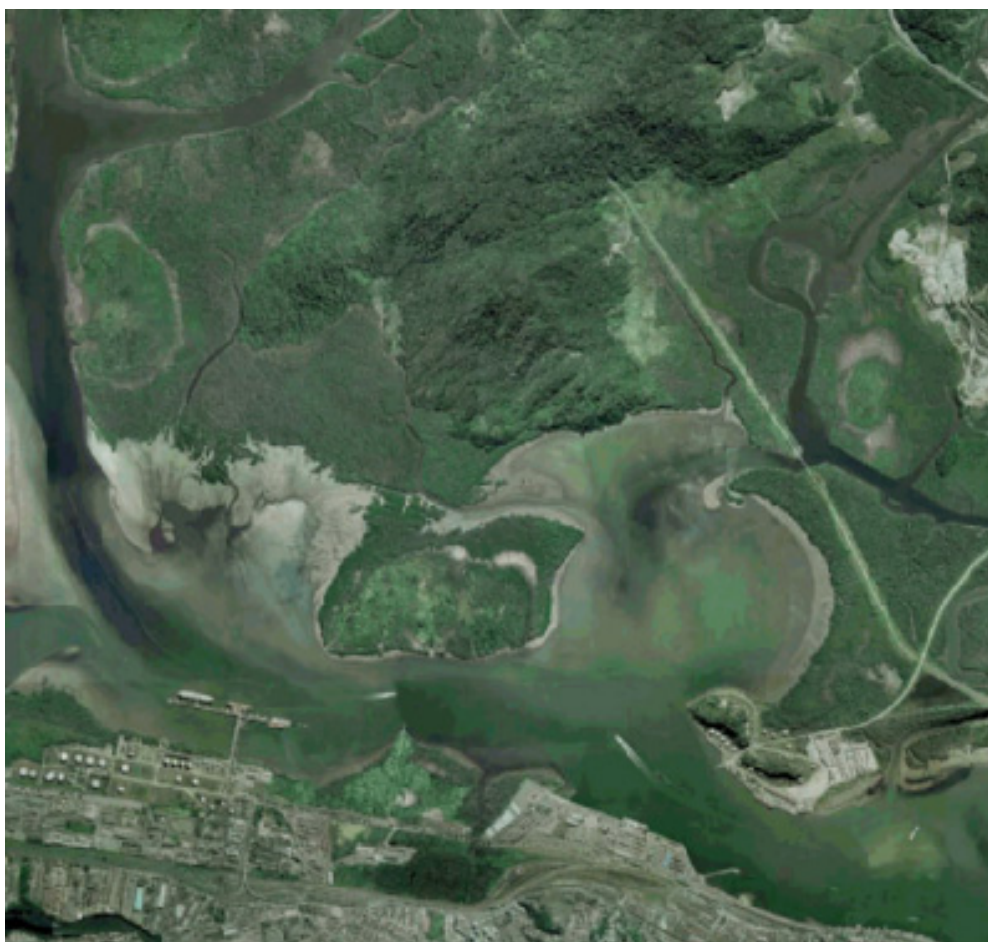
Foto 9.3-4 Terrenos da Baixada Santista nos arredores da Alemoa, Largo do Caneú, e onde predominam os depósitos associados à Planície de maré e Baixios. No centro da foto, bacia de evolução do Terminal Público da Codesp / Terminal da Petrobras.
