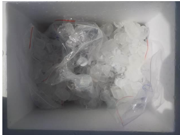
Figura 2.9.5.2.1-14 – Preservação das amostras em caixas térmicas com gelo.
