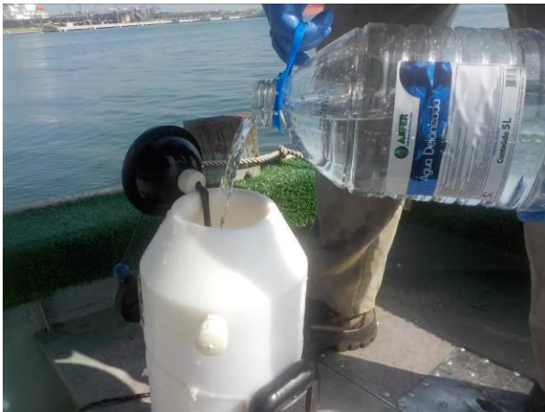
Figura 2.9.5.2.1-13 – Lavagem da garrafa Van Dorn , com água deionizada, para realização do branco de campo/equipamento.
