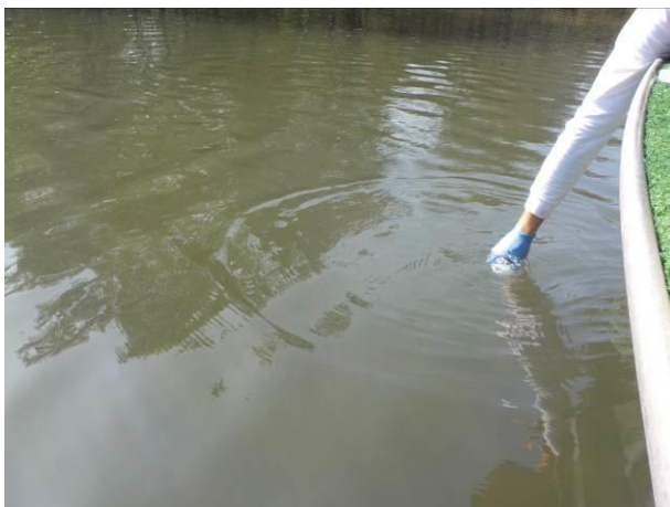
Figura 2.9.5.2.1-11 – Amostragem de água superficial por imersão direta dos frascos sem preservantes.
