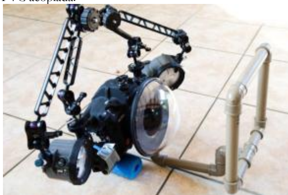
Figura 2.8.2.3.5-4: Caixa estanque com a armação de PVC acoplada.
