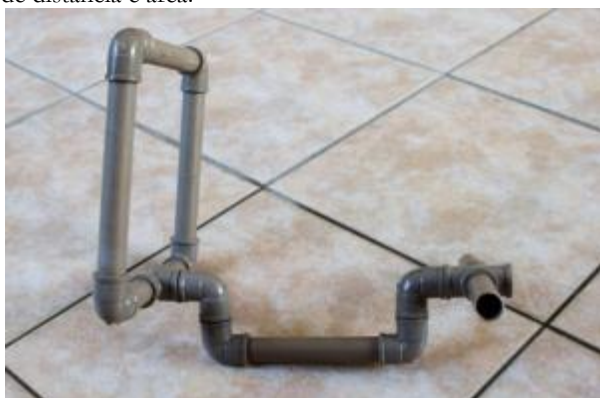
Figura 2.8.2.3.5-3: Armação de PVC para padronização de distância e área.
