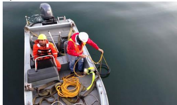
Figura 2.11.6.1-14 – Utilização do detector de metais superficial.
