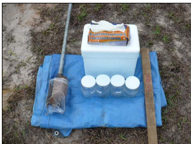
Figura 5.1.3.2-9: Materiais utilizados no procedimento de amostragem de solos por tradagem.
