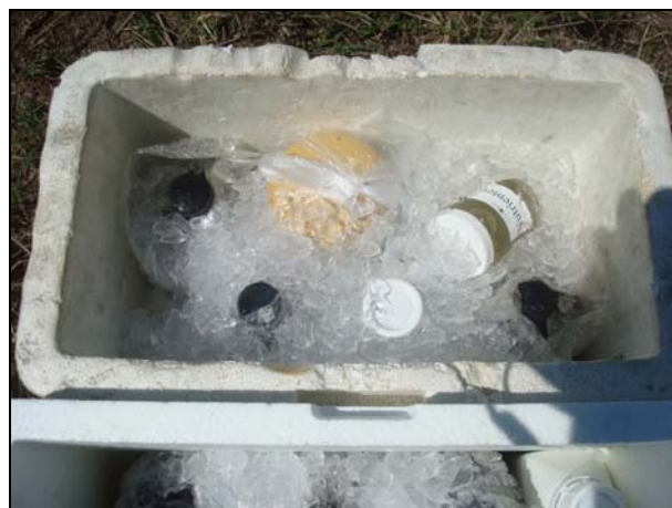
Figura 5.1.3.2-18: Finalização do procedimento de acondicionamento das amostras em caixa térmica com gelo.
