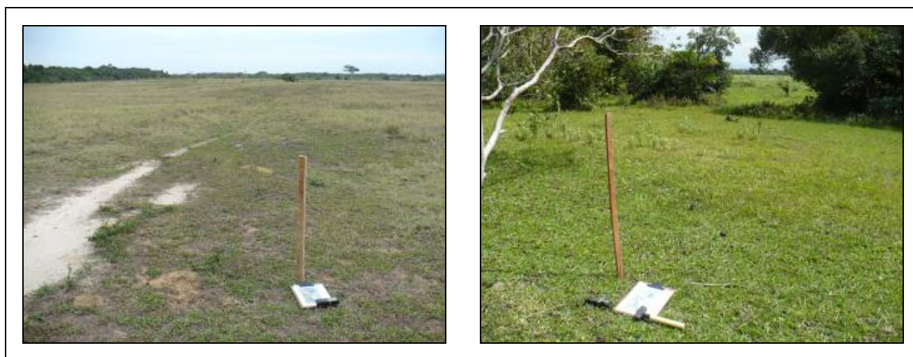
Figura 5.1.5.2-1: Atividades iniciais de estaqueamento e geoposicionamento dos pontos de sondagens em campo.
