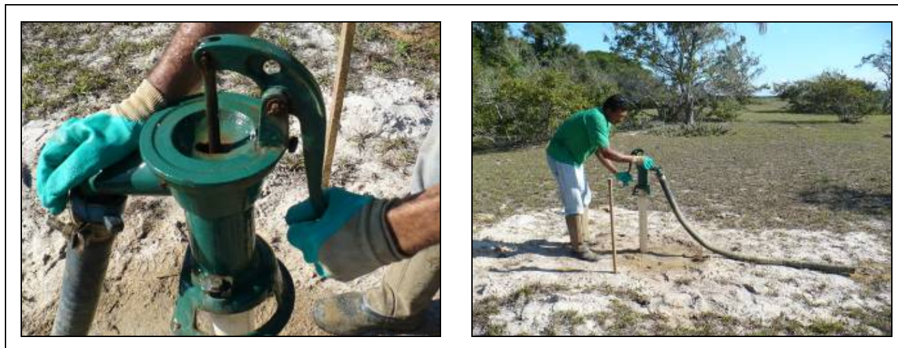
Figura 5.1.5.2-6: Imagens mostrando as operações de limpeza dos poços provisórios utilizando-se bomba manual de esgotamento.
