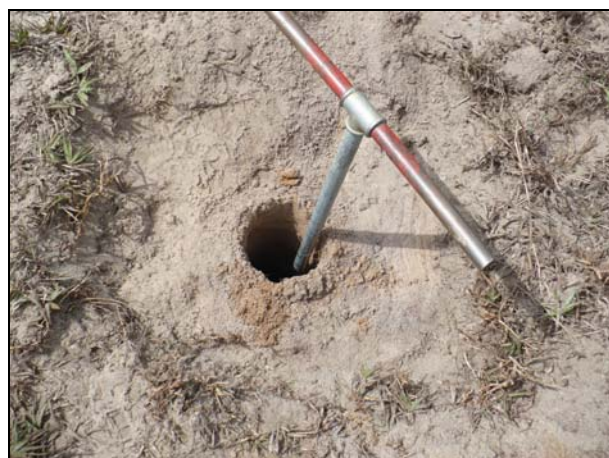
Figura 5.1.3.2-10: Procedimento de tradagem para coleta de amostra de solo subsuperficial.
