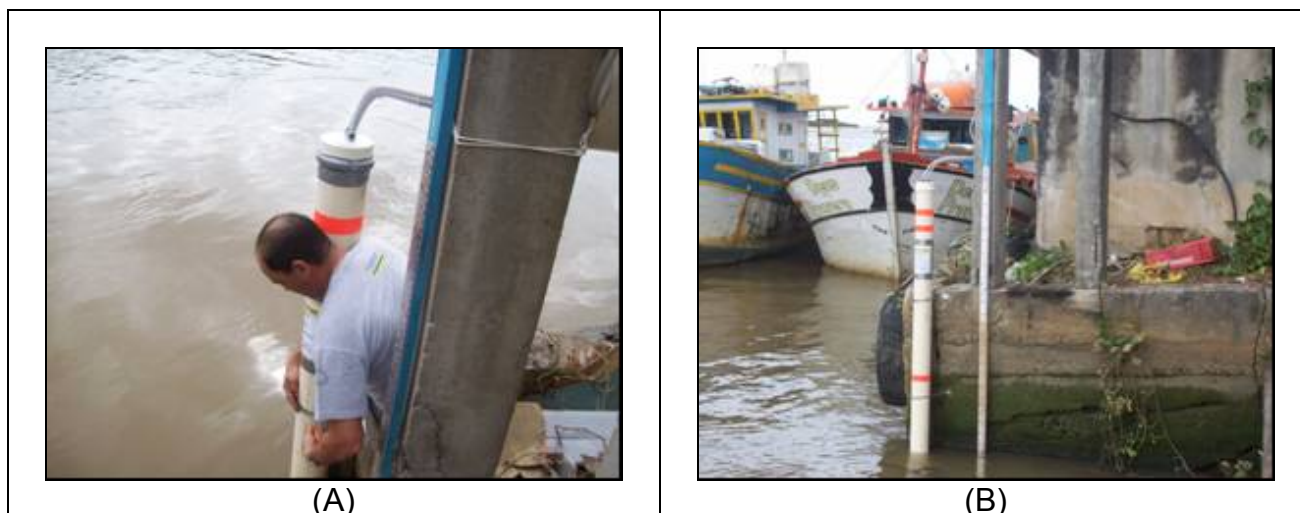
Figura 5.1.6.1-4– Medição de nível de água próximo à foz do rio Itabapoana (RJ) junto à margem direita: (A) instalação e fixação do tubo de PVC; (B) medidores instalados junto à régua limnimétrica.
