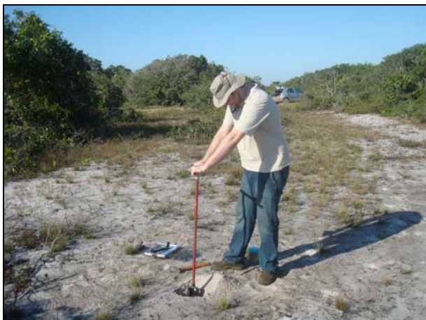
Figura 5.1.3.2-13: Procedimento de remoção de amostra subsuperficial por tradagem.
