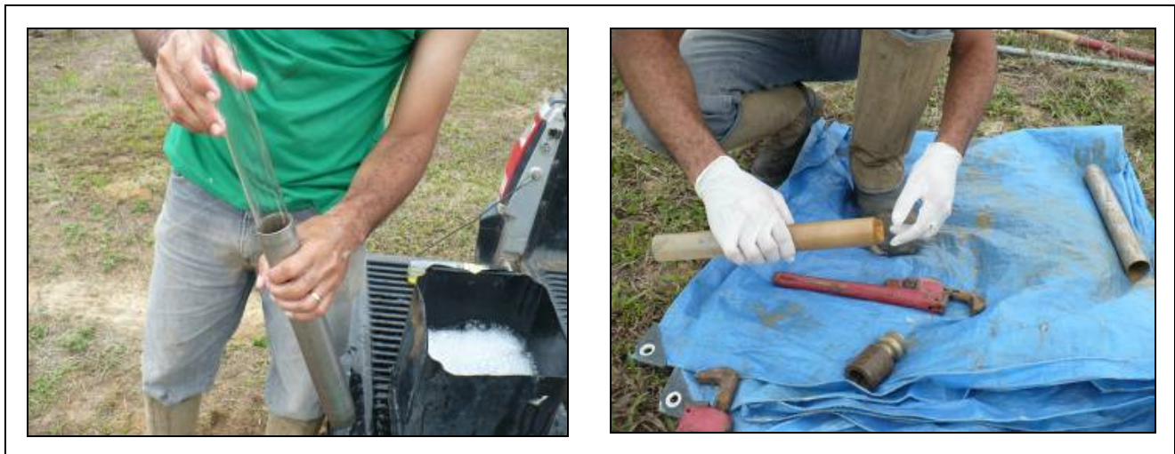
Figura 5.1.5.2-5: Imagens do liner antes e depois da coleta de amostra de solo em perfuração na área de estudo.
