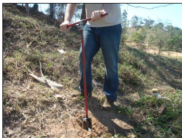
Figura 5.1.3.2-16: Realização de furo externo em solo para amostragem.
