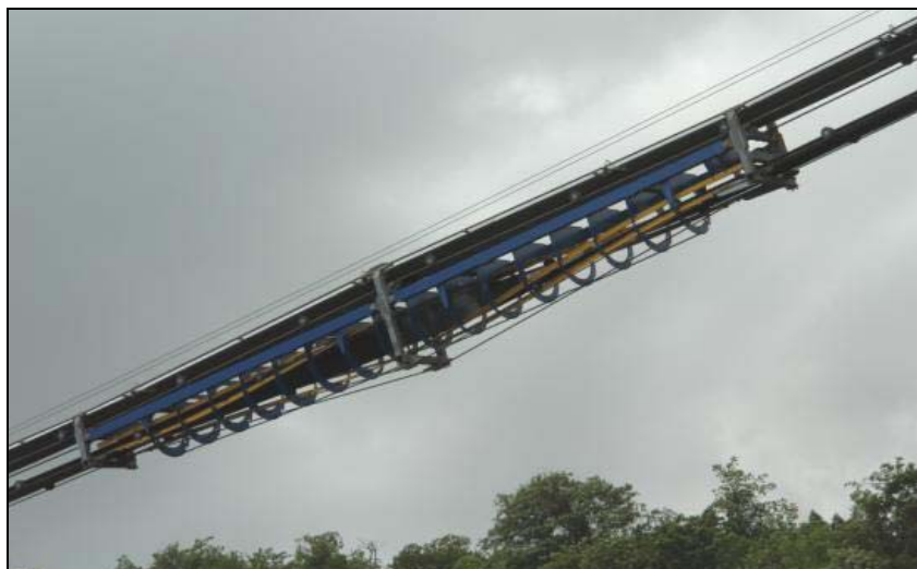
Figura 3.1.1.1-4: Detalhe do virador de correia de um transportador RopeCon.
