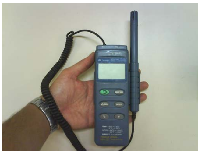
Figura 5.1.16: Termo-higrômetro digital para medição de temperatura e umidade durante amostragem.
