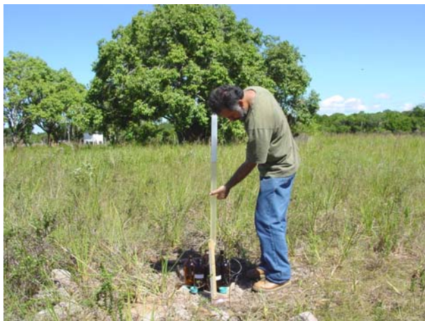
Figura 5.1.5: Detalhe da coleta de amostras no poço de monitoramento PM-7, através de bailer.
