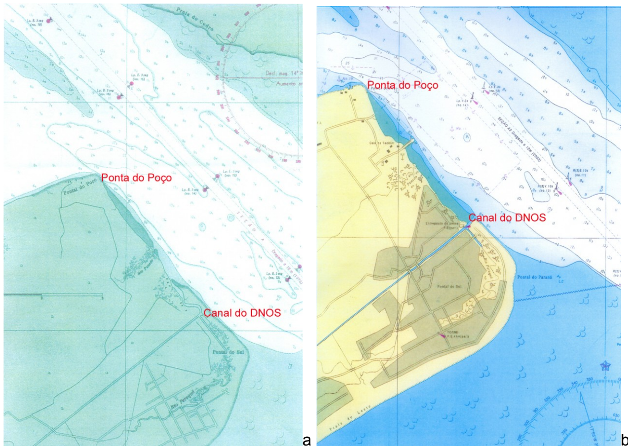
Figura 5: Carta Náutica N° 1.821 edição (a) de 1976 e (b) de 2004. Notar o recuo da linha de costa entre o Canal do DNOS e a Ponta do Poço.
