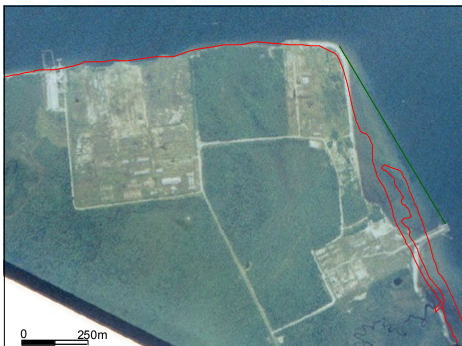
Figura 3: Superposição da linha de costa em 1953 (linha vermelha) na fotografia aérea de 2003 e linha aproximada do cais do TCPP (linha verde).
