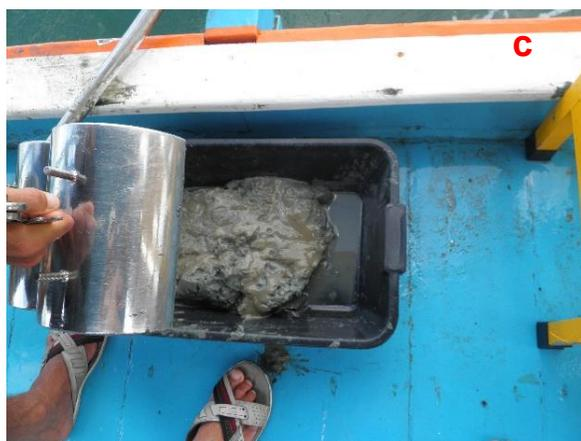
Figura 5: a) Estação de coleta 4, na Baía de Aratu, na área de influência da Ford, no município de Candeias, Bahia; b) draga de *Holme* sendo lançada para arrasto; c) draga de *Petersen* com sedimento sendo aberta sobre bandeja para posterior lavagem em peneira.
