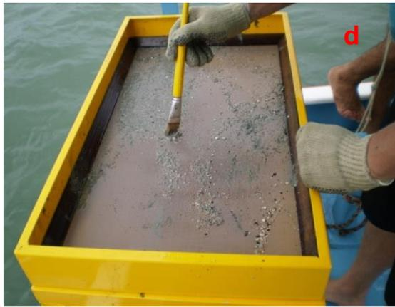
Figura 2: a) Estação de coleta 1, na Baía de Aratu, na área de influência da Ford, no município de Candeias, Bahia; b) draga adaptada de *Holme* pronta para ser lançada na água; c) sedimento sendo lavado sobre peneira; d) porção fina do sedimento sendo retirada com auxílio de pincel para não danificar os organismos.
