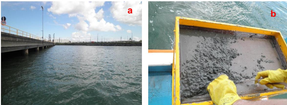
**Figura 6: a) Estação de coleta 5, na Baía de Aratu, na área de influência da Ford, no município de Candeias, Bahia; b) sedimento em processo de lavagem na peneira.**
