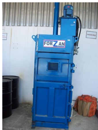
Fotografia 30 - Prensa Hidráulica do Entreposto Tainha
