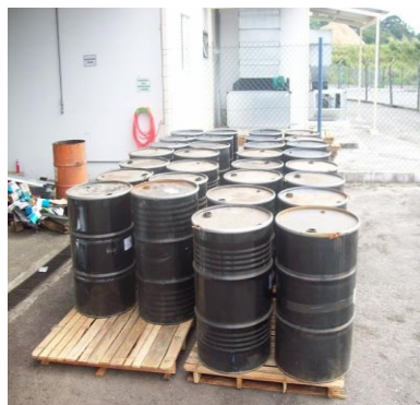
Fotografia 24 – Tambores Metálicos de armazenamento de resíduos perigosos.
