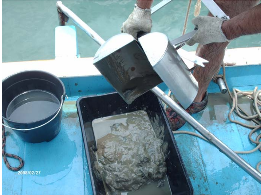
Figura 7: Draga de Petersen utilizada para a dragagem e respectivo sedimento dragado.
