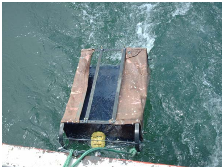
Figura 8: Draga adaptada do modelo proposto por Holme (1971), com malha de 5mm de abertura.
