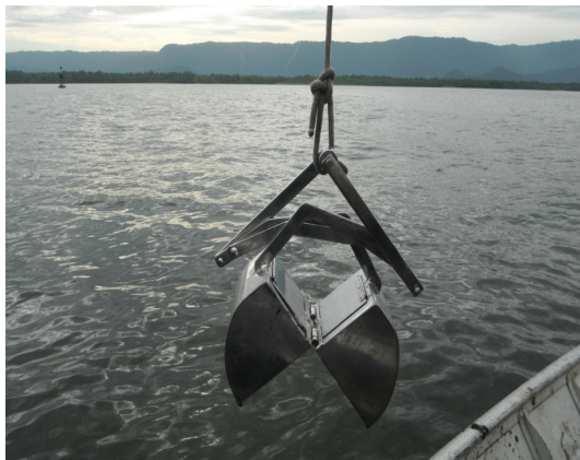
Figura 03. Pegador de fundo no momento do lançamento para amostragem de sedimento superficial.
