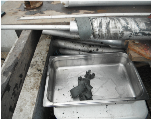
Figura 07. Instrumento de aço inox utilizado para auxiliar na retirada do sedimento em profundidade do core .
