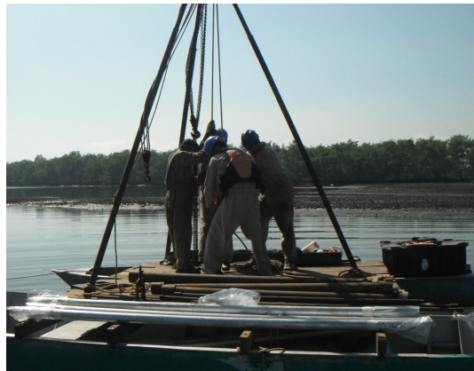
Figura 06. Inserção do tubo de alumínio (core) para coleta do sedimento em profundidade.
