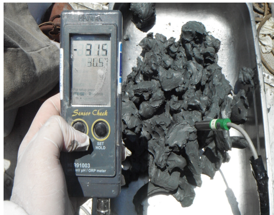
Figura 10. Sonda multiparâmetros da marca HANNA, modelo 991003, utilizada para medição dos parâmetros físico-químicos do sedimento.
