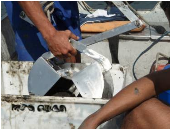
Figura 7.2.2.5-7. Coletor de sedimento: draga van Veen.
