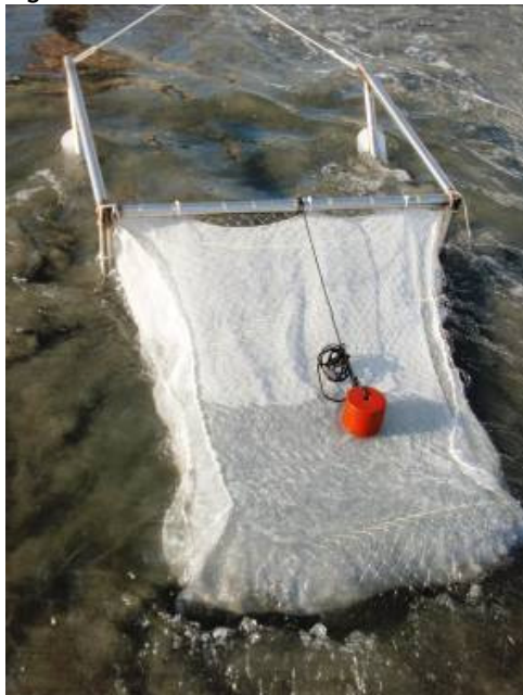
Figura 7.2.2.2-3: Beam Trawl utilizado para amostragem de indivíduos pós-larva e jovens de camarão
