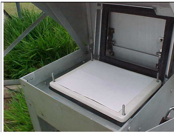
Figura 7.1.3.7.1 - 2: Tampo aberto destaca filtro que captura o PTS. Antes das coletas, o filtro está branco.
