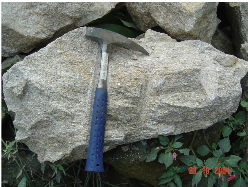
Figura 7.1.4.1.2 - 1: Amostra de rocha granitóide pertencente à unidade 22 - Maciço Granitóide Morrão, que aflora localmente em cortes dos taludes das ferrovias que ligam o Planalto à Baixada Santista.
