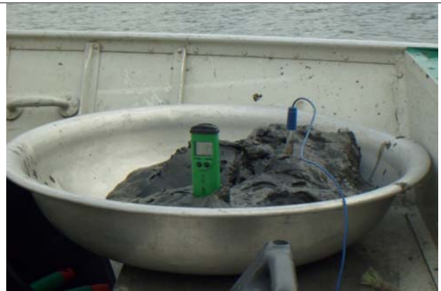
Figura 8: Realização das medidas físico-químicas in situ no sedimento.
