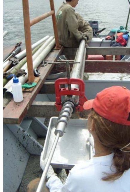
Figura 4: Retirada do sedimento do cano de alumínio com auxílio de sacador.
