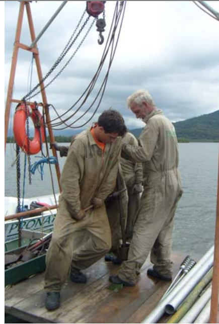
Figura 2: Inserção do cano de alumínio por dentro do tubo de encamisamento para coleta de sedimento.
