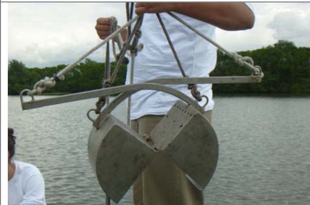
Figura 7: Draga Van Veen utilizada para coleta de sedimento superficial.
