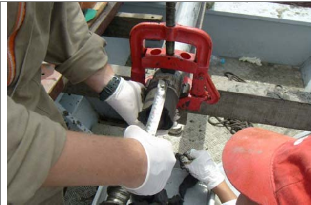
Figura 5: Medição da quantidade de sedimento retirado do cano de alumínio.
