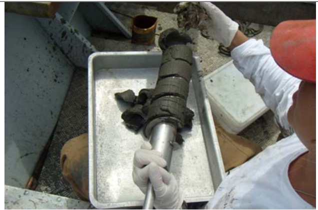
Figura 6: Sedimento retirado colocado em bandejas de alumínio.
