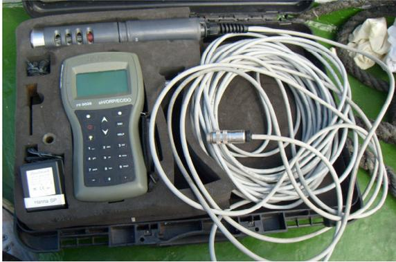
Figura 1: Sonda multiparamétrica da marca HANNA, utilizada para as medições físico-químicas *in situ* na água.
