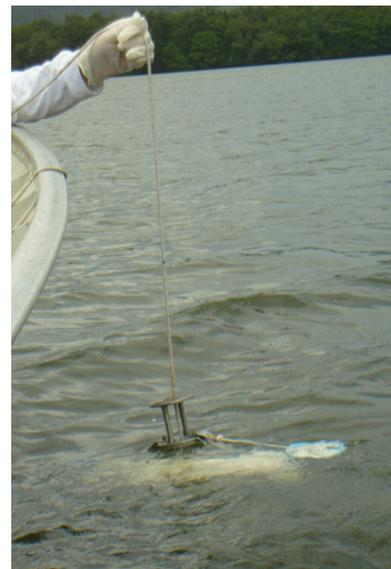
Figura 6: Imersão da garrafa "Van Dorn" para amostragem de água de profundidade.
