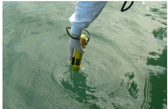
Figura 4: Profundímetro da marca Speedtech, utilizado para medir a profundidade.
