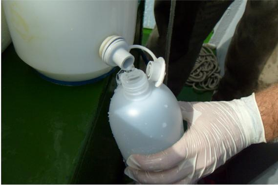
**Figura 7: Acondicionamento das amostras de água em frascos apropriados.**
