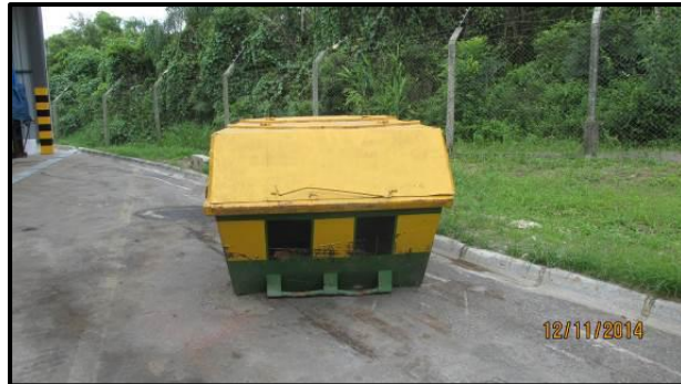
Figura 7 - Caçamba coberta para armazenar resíduos não perigosos e não recicláveis (rejeitos).
