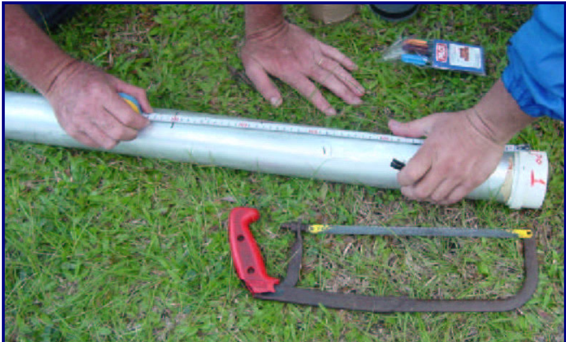
Foto 8.1- 22-Divisão do testemunho para preparação de amostras
