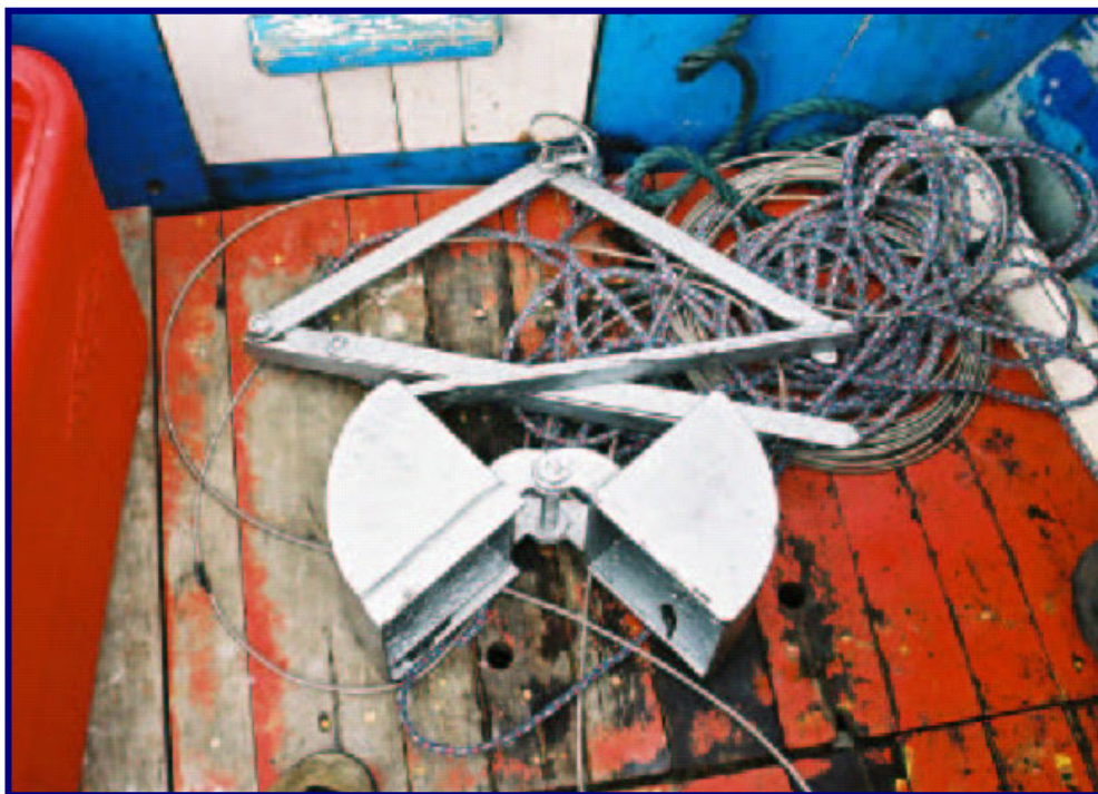
Foto 8.1- 20– Pegador de Fundo do Tipo Van Veen para Coleta de Sedimento Superficial
