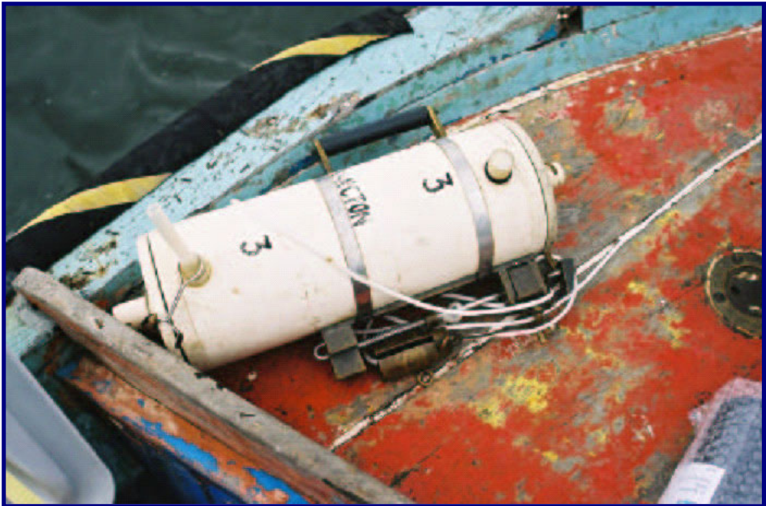
Foto 8.1- 17 – Garrafa de Van Dorf utilizada para a coleta de amostras de água de fundo
