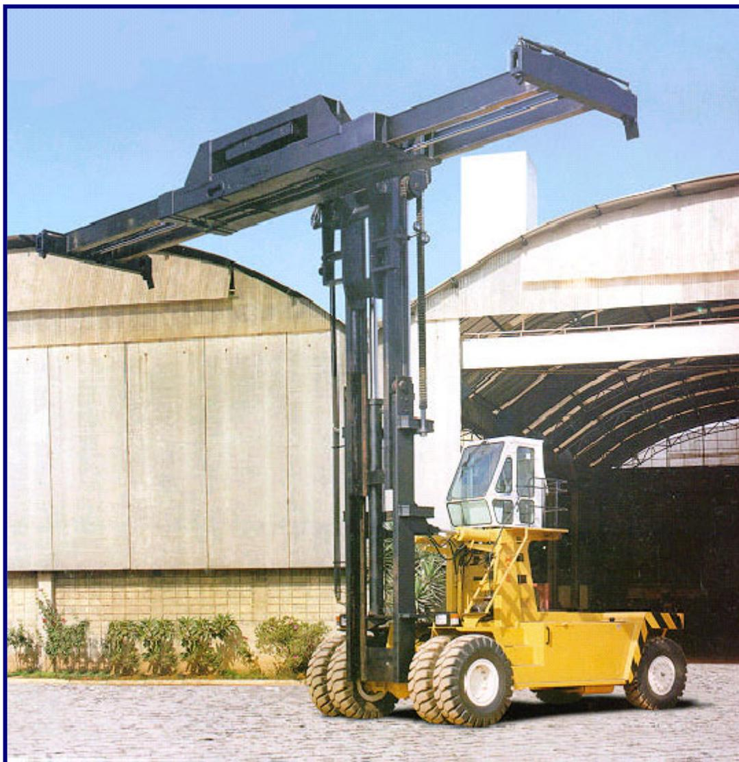
**Foto 6.4 - 5- "Top Loader" para Movimentação Interna de Contêineres Vazios**
