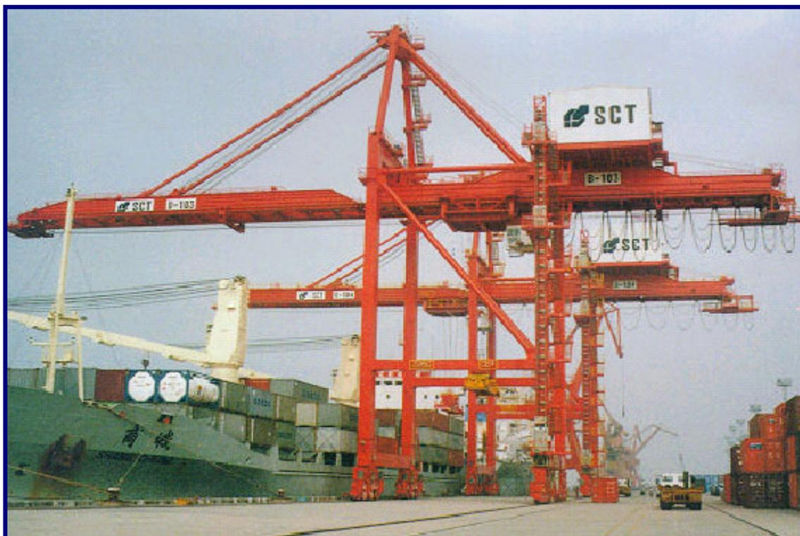
**Foto 6.4 - 1 - Guindaste-Pórtico ("portêiner") para Transferência de Contêineres entre Embarcação/Cais**
