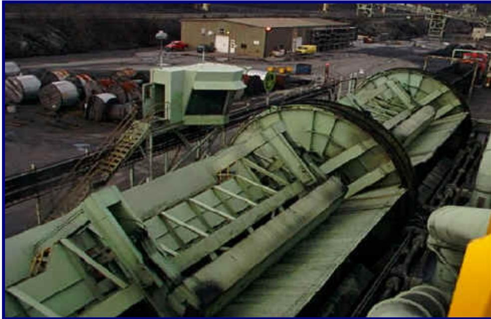
**Foto 6.4 - 7- "Car Dumper" (equipamento que inverte vagão ferroviário para descarga de granéis sólidos em moega)**
