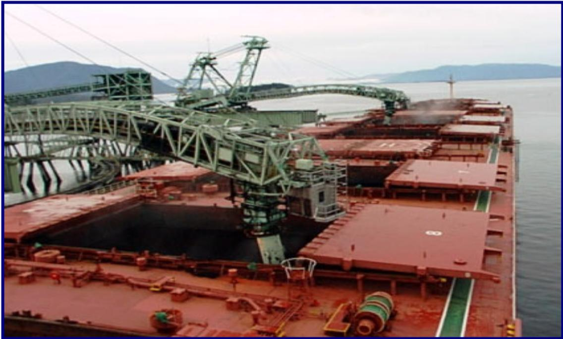
**Foto 6.4 - 2– “Ship Loader” para Granéis Sólidos**
