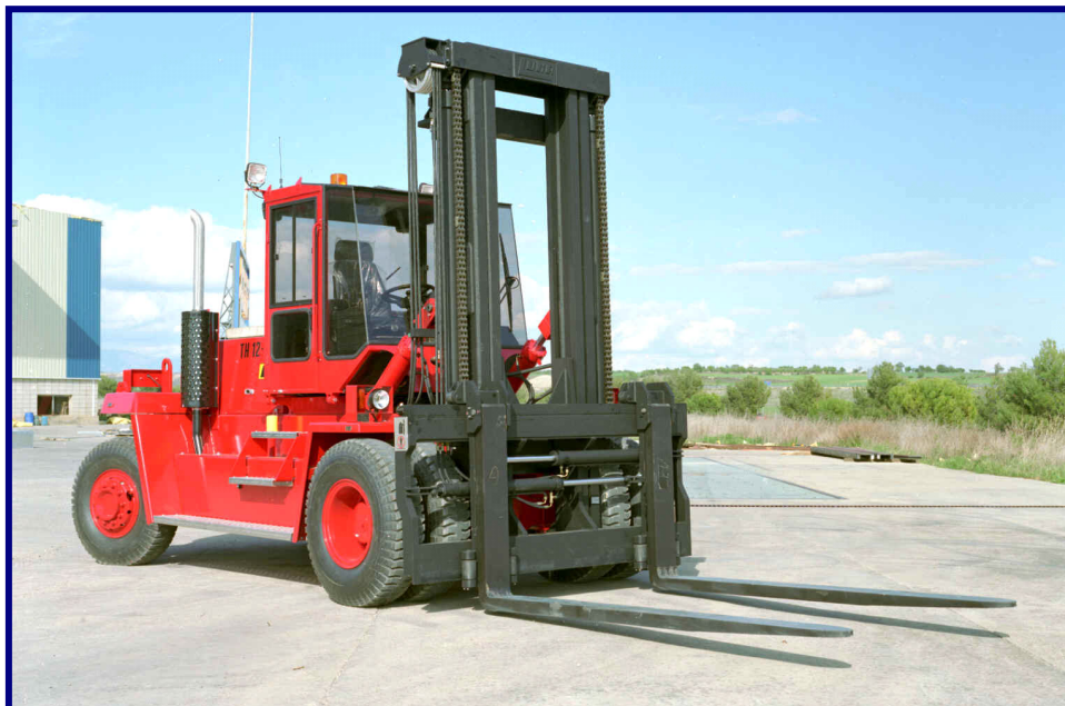
Foto 4.4 - 6 -Empilhadeira de Garfo para Movimentação Interna de Contêineres Vazios
