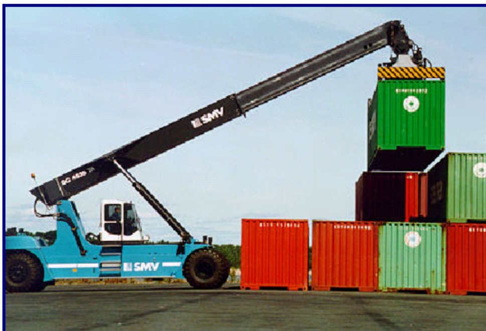
Foto 4.4 - 3- "Reach Stacker" para Movimentação Interna de Contêineres
