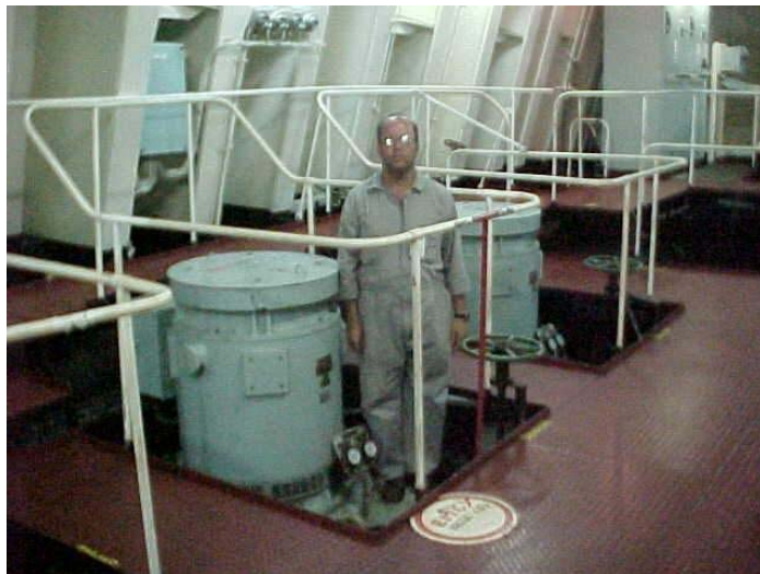
Figura 2 – Foto de um tipo de bombas d' água localizadas na praça de máquinas, destinadas a lastrear e deslastrear o navio.. Fonte: Foto de arquivo (2004)
