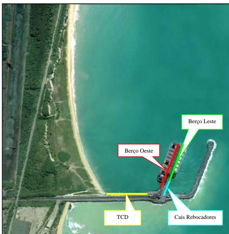
**Figura 4.2-1: Vista da estrutura dos cais de atracação do Terminal Marítimo Privativo de Uso Misto da Ponta de Ubu.**
