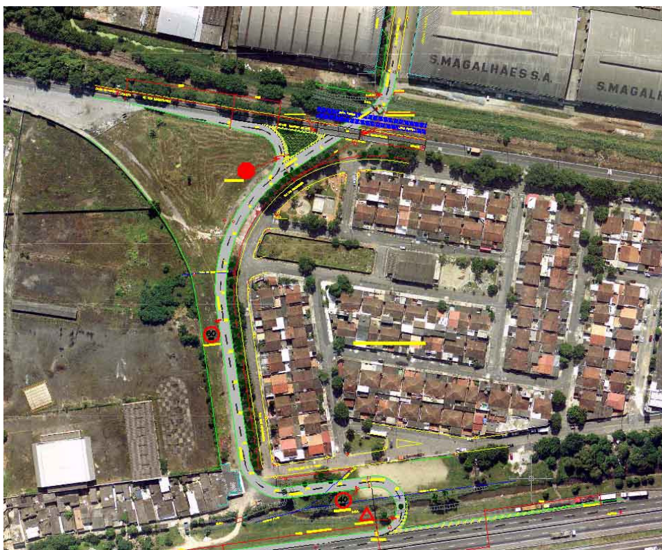
Figura 8.4.5.2 - 22: Proposta de transposição sob a ferrovia junto ao Jardim Piratininga. Transposição apenas para o tráfego saindo da Alemôa e se direcionando à Via Anchieta.
