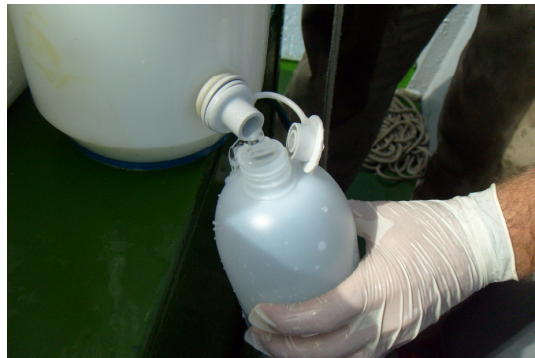
Foto 8. Acondicionamento das amostras de água em frascos apropriados.
