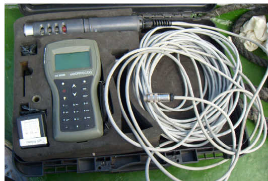
Foto 4. Sonda multiparamétrica da marca HANNA, utilizada para as medições físico-químicas in situ na água.
