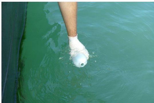
Foto 1. Amostragem de água superficial, através da imersão direta dos frascos no corpo de água.
