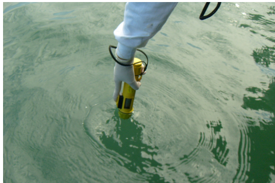
Foto 7. Profundímetro da marca Speedtech, utilizado para medir a profundidade
