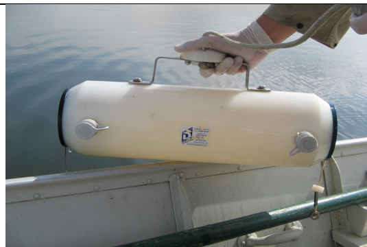
Foto 2. Garrafa do tipo van Dorn utilizada para coleta de água em profundidade.
