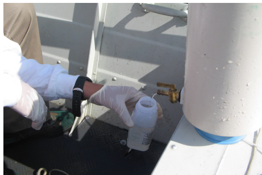
Foto 1. Amostragem de água superficial, através da imersão direta dos frascos no corpo de água.
