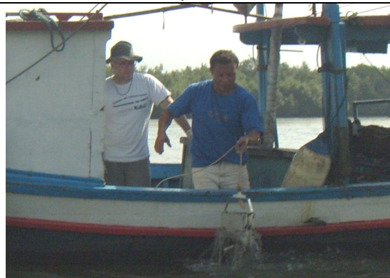
Figura 3 - Retirada da draga tipo Petit Ponan da coluna d'água contendo organismos bentônicos.
