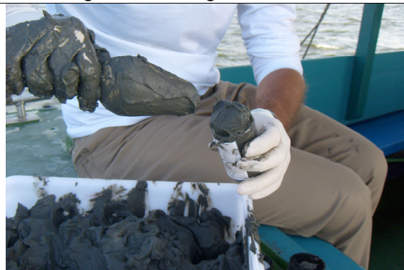
Figura 3 - Retirada da draga tipo Petit Ponan da coluna d'água contendo organismos bentônicos.
