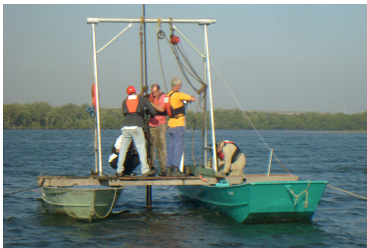
Figura 7 - Sistema de bate estaca para a inserção do tubo de amostragem e sistema de roldanas para retirada do mesmo do sedimento.
