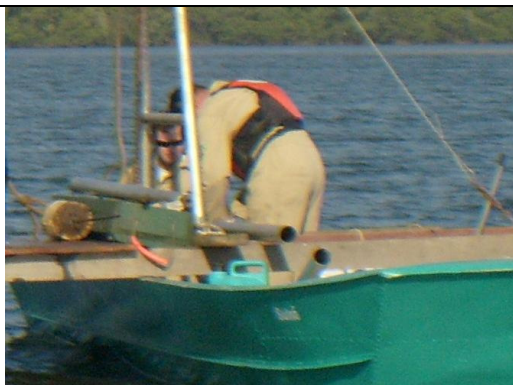
Figura 2 - Retirada de amostra de sedimento sub-superficial do tubo coletor de alumínio.
