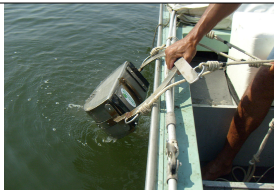
Figura 1 - Retirada da draga do tipo Van Veen contendo sedimento superficial.
