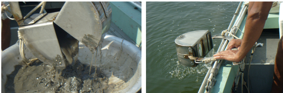
Figura 6 - Draga do tipo Van Veen utilizada para coleta de sedimento superficial
