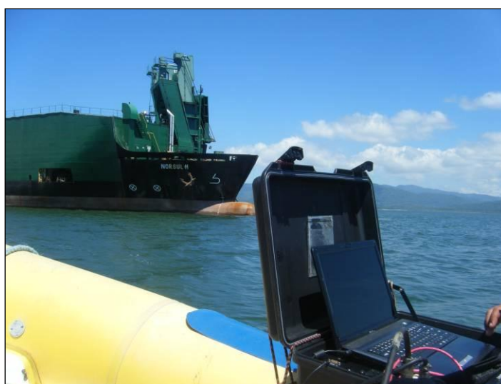
Figura 5. Ecobatímetro ODOM/ECHOTRAC™ - com microcomputador que permite o registro dos dados, instalado na embarcação.
