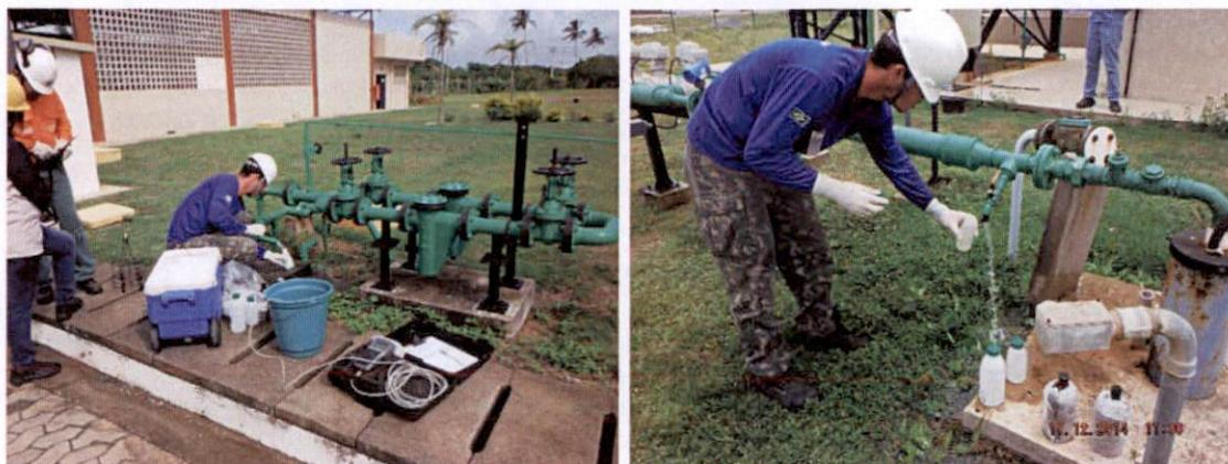
**Figura 4-1:** Coleta de água subterrânea nos poços Artesiano, à esquerda, e Tubular Profundo, à direita.
