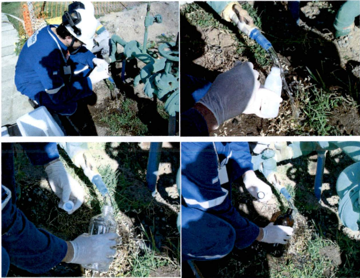
Figura 3: Coleta de amostras da água do Poço Tubular Profundo, saída de água da bomba.
