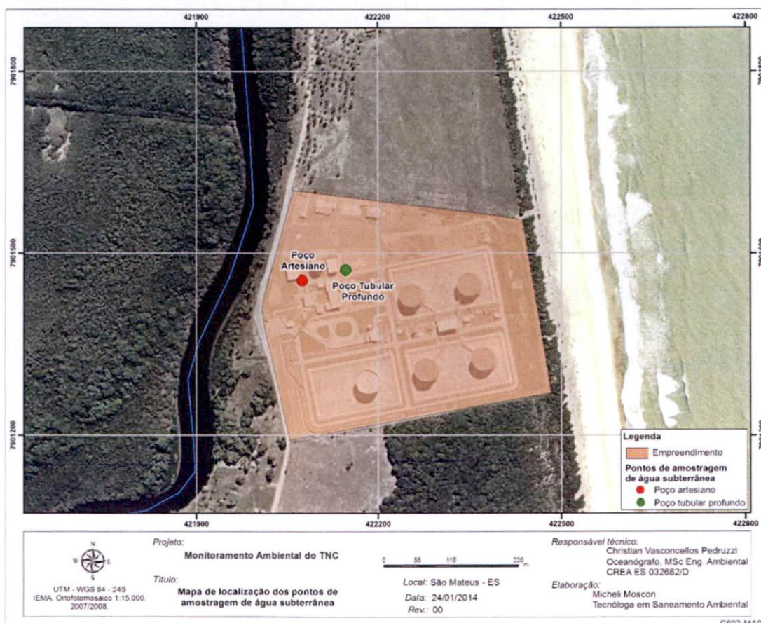
Figura 3-1: Pontos de coleta de água subterrânea nos poços Artesiano e Tubular Profundo.
