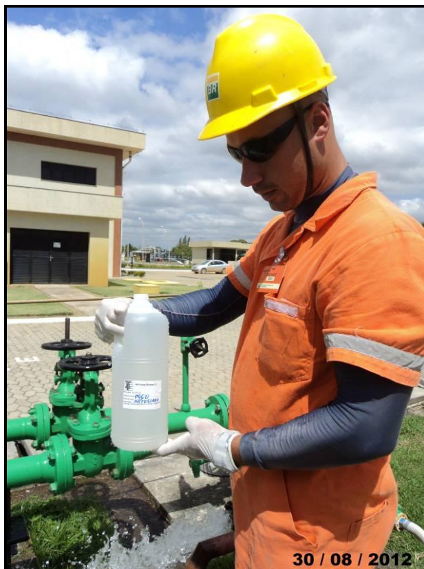
Figura II.1-2 - Coleta de água na saída da bomba do poço artesiano
