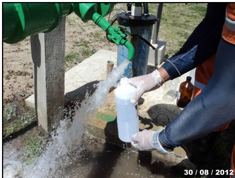
Figura II.1-1 – Coleta de água na saída da bomba do poço tubular profundo.
