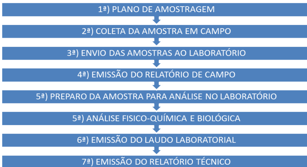
Figura 3 - Procedimentos operacionais de monitoramento da água de poço tubular profundo do TNC.
