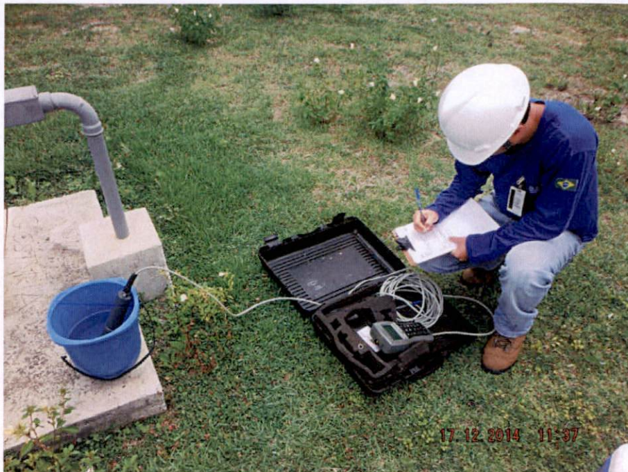
Figura 6-2: Medição dos parâmetros físico químicos in situ no poço tubular profundo.
