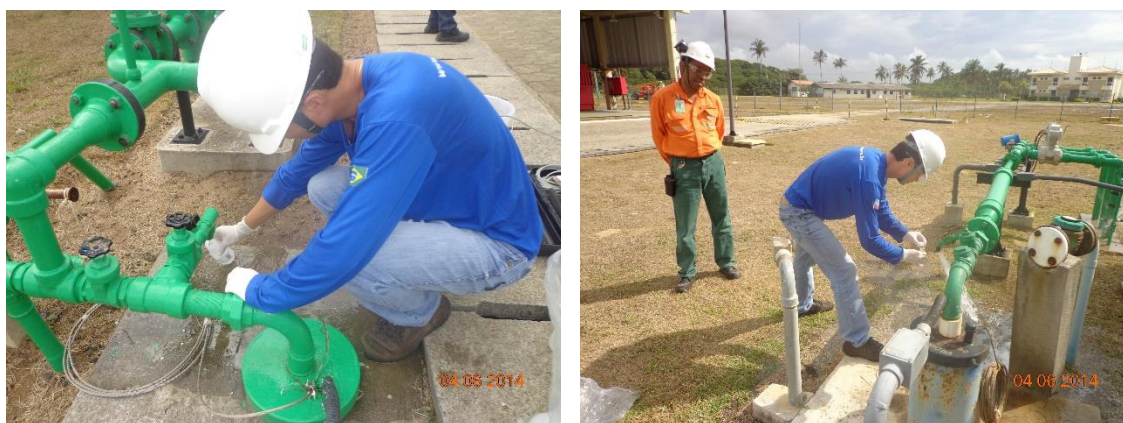
Figura 4-1: Coleta de água subterrânea nos poços Artesiano, à esquerda, e Tubular Profundo, à direita.
