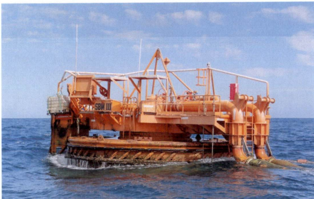
Figura 4 – Monoboia que será instalada no TNC – SBM III
