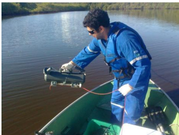
Figura 9: Uso de garrafa de Von Dorn para coleta de amostras da água do Rio Barra Nova.
