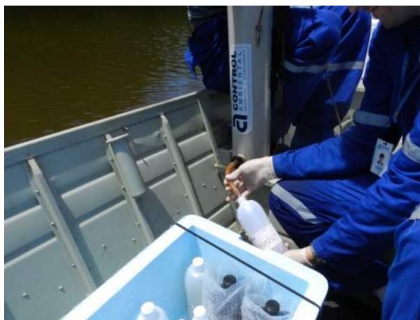
Figura 9: Uso de garrafa de Von Dorn para coleta de amostras da água do Rio Barra Nova.
