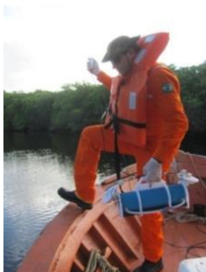
Figura 10: Uso de garrafa de Von Dorn para coleta de amostras da água do Rio Barra Nova.
