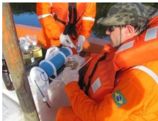
Figura 10: Uso de garrafa de Von Dorn para coleta de amostras da água do Rio Barra Nova.
