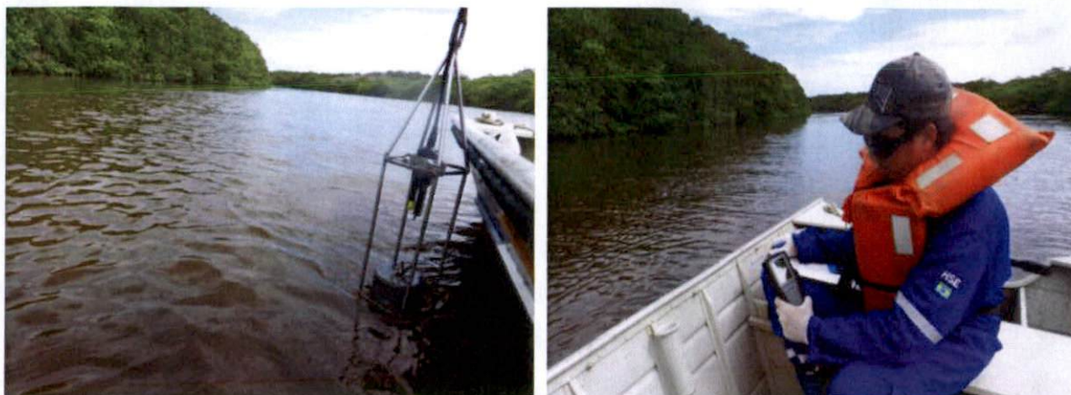
Figura 11: Uso de sonda Hydrolab para registro de dados em campo.
