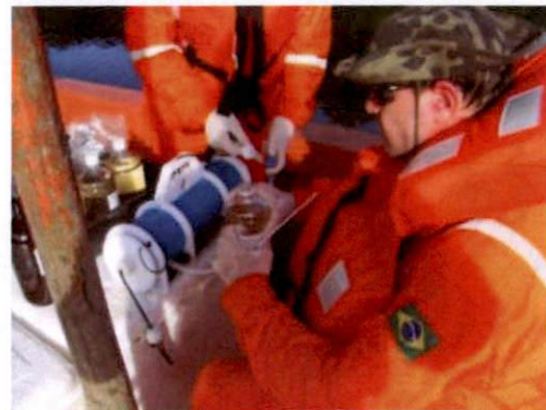
Figura 10: Uso de garrafa de Von Dorn para coleta de amostras da água do Rio Barra Nova.
